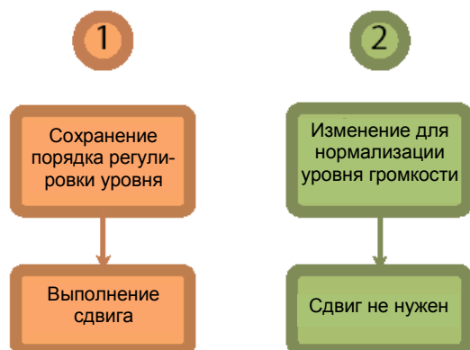
Рис. 4 Два принципиальных метода работы для получения однородной громкости в производстве и постпроизводстве
